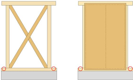
アンカーボルトが無い場合、地震等の外力により土台の浮き上がりや基礎からのズレが生じる。
